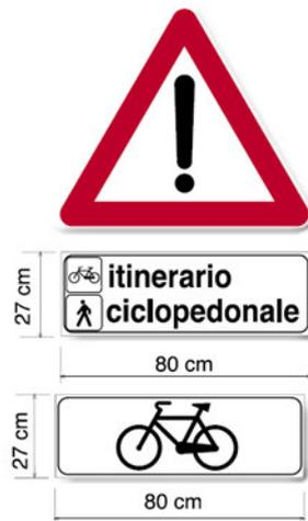
Fig 4: Possibile cartello di pericolo generico (fig. II, art 103 DPR 495/92, con pannello integrativo, (mod II 6 art 83 DPR 495/92) da porre su strada a viabilità ordinaria per segnalare la frequente e probabile presenza di ciclisti, ovvero dell'itinerario ciclopedonale (Eventualmente da utilizzarsi abbinato a limite di velocità 30 o meno vedi Tab 6c)
