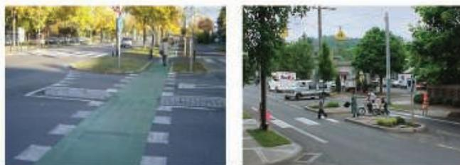
**Figura 4** - Un'isola spartitraffico sormontabile (a sinistra), realizzata in prossimità di una rotonda per separare i flussi veicolari e un'isola non sormontabile (a destra), che è preferibile in quanto aumenta la sicurezza dei pedoni durante l'attraversamento
