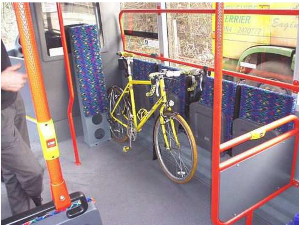
fig. 2c Trasporto della bici all'interno dell'autobus
