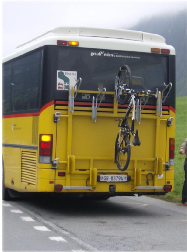
fig. 1a Portabici posteriore. Versione 1 con bici verticale
